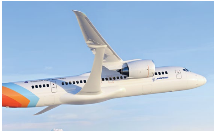
Pesawat X-66A menggunakan rangka aerodinamis untuk menopang sayap yang panjang dan ramping.
